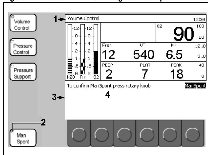
Figure 30. ManSpont Ventilation Screen
